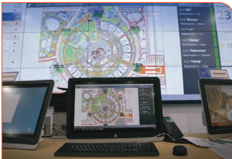
■ Con CAME Connect le automazioni sono gestibili da remoto. Il software installato presso la control room permette di monitorare real time e in modo centralizzato il sistema di controllo accessi
