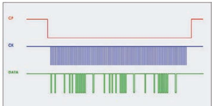
L'interfaccia tra il lettore e il Controller per accessi è costituita da tre segnali: Card Present (ciclo di lettura in corso), Clock (sincronismo) e Data (valore del dato). Nella versione ridotta (Clock & Data) il segnale CP non è usato. © a&s Italy All rights reserved
