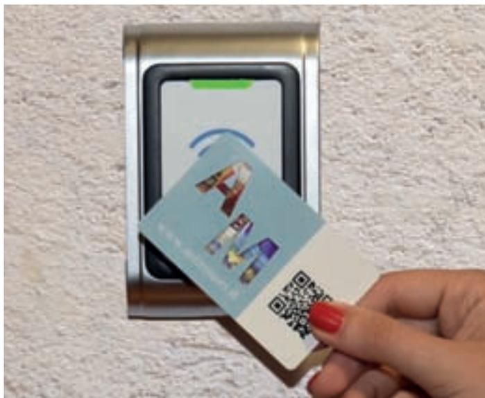
**Il riconoscimento e l'ingresso dei visitatori ai siti è gestito da un'unità elettronica di controllo accessi di ultima generazione. I lettori sono anti-vandalo e waterproof. (Courtesy: Elex srl).**
