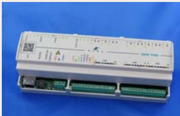
**Il Controller Elex Idris®, nella foto in versione DIN rail, dispone di ben nove tipi di interfacce**
