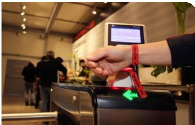
■ Il software appositamente progettato e i 4 tornelli XVia consentono di gestire diversi livelli di accesso alle diverse aree del circuito tramite braccialetti NFC
