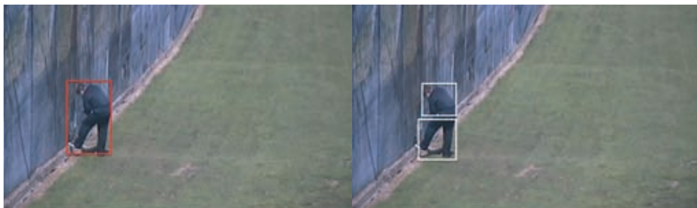
Figura 3: Uno dei fotogrammi estratti dal dataset iLIDS ( https://www.gov.uk/imagery-library-for-intelligent-detection-systems ). Sulla sinistra vi è un esempio del sistema antintrusione AI-INTRUSION ( http://www.aitech-solutions.eu/ai-intrusion/ ) che funziona correttamente: la persona viene rilevata e l'allarme antintrusione, come visibile dal rettangolo rosso, viene generato. Al contrario, nel fotogramma a destra vi è un esempio di algoritmo antintrusione che non funziona correttamente a causa di un errore nella fase di detection: la persona viene infatti spezzata in due parti (identificata ciascuna dal rettangolo bianco), ma nessuna di tali parti assume la forma di una persona. Pertanto, l'allarme non può essere generato.
