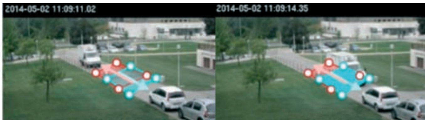
Figura 2: Due spire virtuali (una rossa e una blu, con differenti versi di percorrenza) disegnate dall'utente per il conteggio di veicoli: non appena un veicolo attraversa una spira nella direzione selezionata dall'utente, il contatore associato viene incrementato. Per maggiori informazioni sui sistemi di conteggio dei veicoli si può far riferimento ad AI-ROAD ( http://www.aitech-solutions.eu/ai-road/ ), il prodotto di A.I. Tech per il monitoraggio del traffico.
