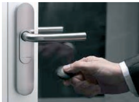
Esempio di lettore wireless (maniglia digitale) installato direttamente sulla porta (Foto: Courtesy SimonsVoss)
