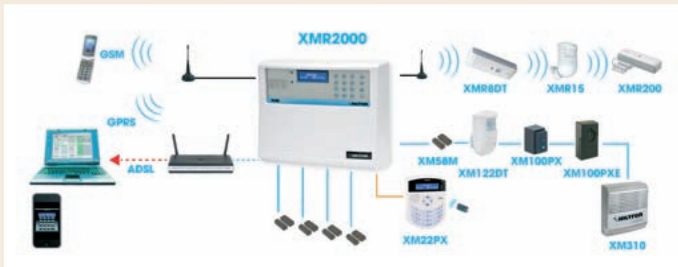
sono programmabili dalla centrale (sensibilità, logica di funzionamento ecc), al pari di quelli installati sulla linea BUS.
