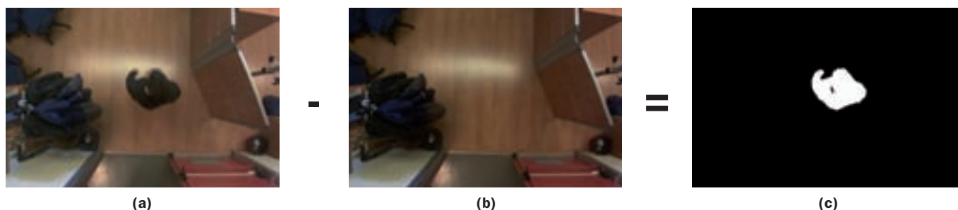
Figura 2: Il rilevamento del foreground all'istante di tempo t è ottenuto per differenza tra (a), il fotogramma acquisito dalla telecamera al tempo t , e (b), il reference frame al tempo t . Il risultato è rappresentato attraverso (c), la maschera di foreground, un fotogramma in cui i pixel bianchi sono associati all'oggetto in movimento, mentre i pixel neri si riferiscono al background.
