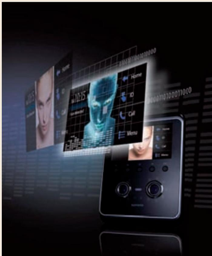
una tecnologia all'avanguardia con avanzati algoritmi proprietari. Un sistema a doppia telecamera rileva contemporaneamente immagini visibili e ad infrarossi, che vengono poi entrambe elaborate con tecniche avanzate di analisi di immagine e classificatori per apprendimento automatico intelligente. Un volto falso viene rilevato stimando caratteristiche specifiche e la loro distribuzione rispetto ai modelli di riferimento di volti reali.
