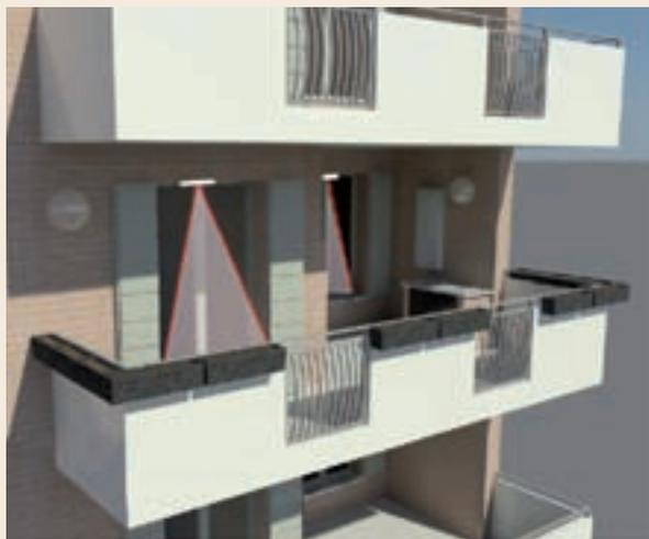
di anticipare l'intrusione lasciando però al contempo libertà di movimento all'interno dell'ambiente protetto. Per le sue dimensioni molto ridotte, è particolarmente indicata per la protezione di porte e finestre e relative serrande o persiane. TRENDY plus, con una portata massima di 5 metri, è disponibile nelle varie versioni sino ad un massimo di 7 fasci. E' dotata di sincronismo ottico ed assicura un'elevata immunità alla luce solare ed agli insetti.
