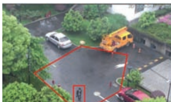
Vagabondaggio (loitering detection): il soggetto staziona in una determinata area per un tempo superiore a quello definito.
