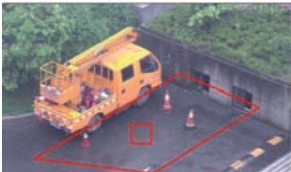
Sottrazione di oggetti (missing object): impostata una determinata area e un tempo minimo di permanenza, rileva l'oggetto sottratto.
