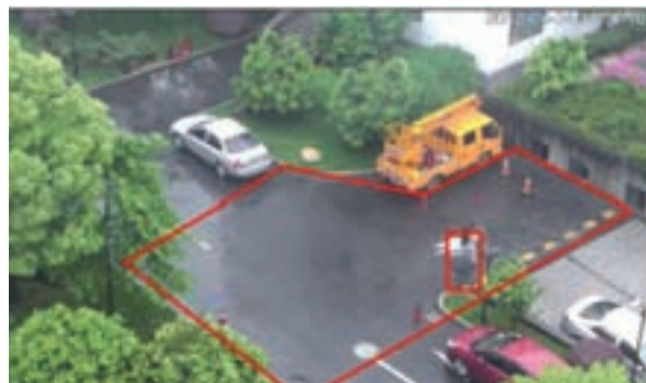
Entrata/uscita o attraversamento di una zona (warning zone). E' possibile personalizzare il numero minimo soggetti e il tempo di permanenza.
