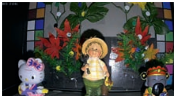
Condizione di ripresa: LED bianco acceso, 0 lux. Il LED a luce bianca integrato illumina la scena e migliora l'efficacia della visione notturna a colori. La ripresa è di ottima qualità.
