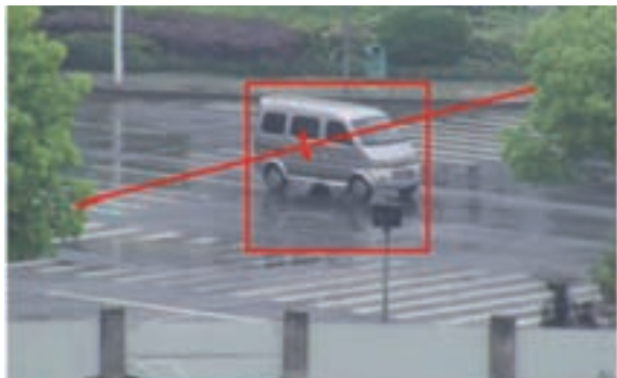
Attraversamento di una linea (tripwire) in una direzione oppure in entrambe le direzioni.
