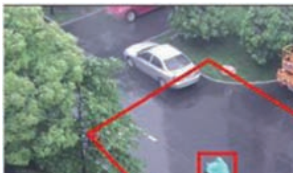
Rilevamento velocità (fast moving): impostata un'area e la velocità massima, rileva gli eccessi di velocità.
