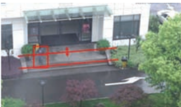
Attraversamento di un perimetro (perimeter protection), ovvero due linee parallele (ad es. una scala, una recinzione). E' possibile definire la direzione.
