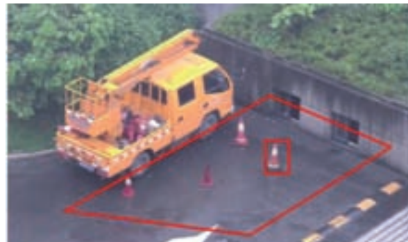
Abbandono di oggetti (abandoned object): impostata una determinata area e un tempo minimo di permanenza, il sistema rileva l'oggetto abbandonato.
