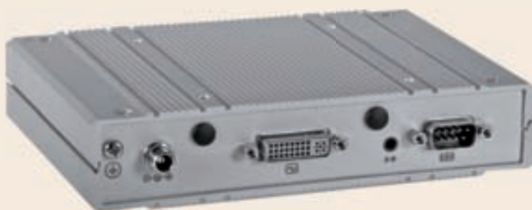
EC800 è il nuovo Embedded System in formato PALM SIZE di DFI , la soluzione ideale per applicazioni che richiedano alte prestazioni mantenendo consumi ridotti, il tutto in uno chassis ultra compatto ricco di I/O e estensioni.
