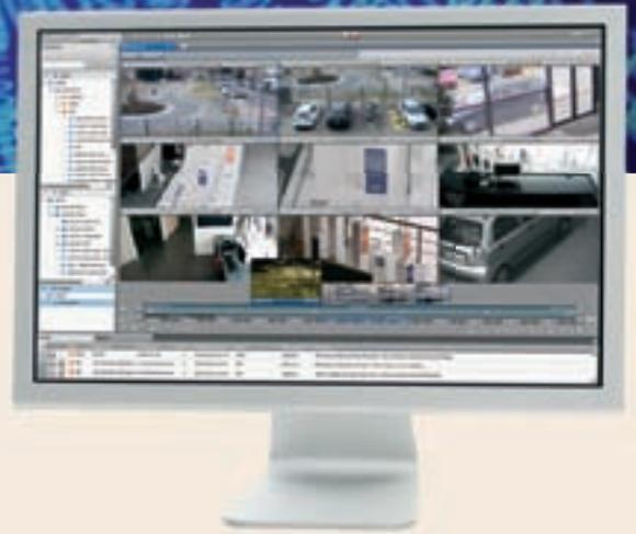
zione della soluzione Command, un potente software di registrazione in grado di gestire fino a 128 canali video IP o analogici. Può essere utilizzato in versione standalone o può essere gestito tramite server Command Enterprise.
