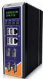
DRPC-100 costituisce la punta di diamante dell'offerta IEI Technology di sistemi Box PC a basso consumo ed è indirizzato in particolar modo ai settori dell'automazione industriale, della building automation e dell'energia. Il range di temperatura estesa -25°+70° C ne consente l'impiego in applicazioni gravose. È dotato di display OLED e tasti funzione programmabili che consentono all'utente di impostare funzioni e visualizzare informazioni di stato direttamente sulla macchina.
