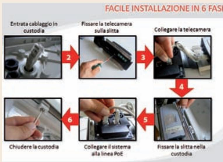
soluzione particolarmente vantaggiosa poiché ha permesso di abbattere notevolmente i costi correlati all'impianto. Il PoE, che non può essere utilizzato per le telecamere analogiche, permette di alimentare i dispositivi di rete grazie ad uno switch PoE o ad un power injector e lo stesso cavo standard di categoria 5 impiegato per la trasmissione di dati e video.
