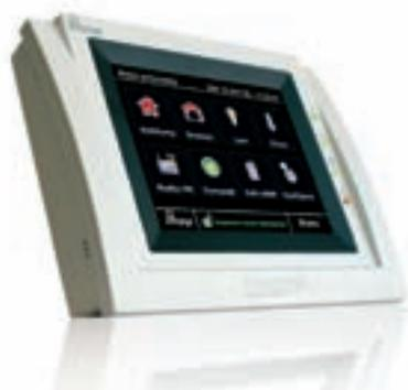
Nuova tastiera Simplya dotata di microfono ed altoparlante per la sintesi vocale
