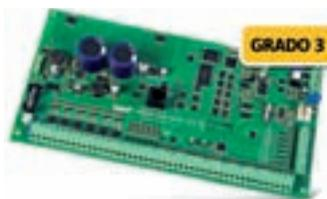
Integra PLUS è la centrale di SATEL con certificazione EN 50131-Grado 3, adatta anche per installazioni in luoghi ad altissimo rischio. Le sue estreme potenzialità di configurazione, l'ampiezza di funzioni e un'alta gamma di accessori, rendono INTEGRA PLUS un prodotto di elevata performance e molto apprezzato per qualsiasi soluzione di installazione.
