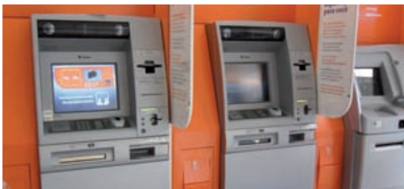
Il sensore biometrico per imaging multispettrale è posizionato a destra della tastiera del bancomat. Foto: Courtesy Lunidigm
