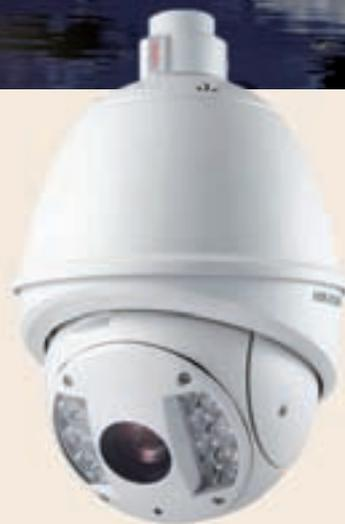
0.02lux@F1.4 in bianco e nero o 0lux per versione con IR (con IR accesi); la qualità di immagine ottimale è inoltre garantita dalla commutazione meccanica del filtro IR durante il passaggio tra colori e b/n, eliminando il problema di perdita del fuoco durante la commutazione.
