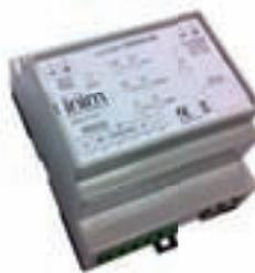
IGKNX100 di Inim Electronics è il gateway che apre le porte della domotica a SmartLiving.
