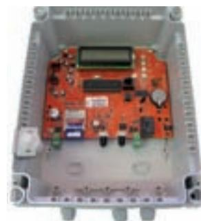
LiteCOPPER protegge i cavi in rame nei tubi e nei pozzetti con tre livelli di sicurezza: preallarme all'apertura del pozzetto, allarme al movimento e taglio cavi e allarme durante la loro estrazione.
