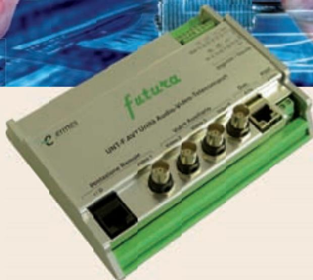
Questa unità consente la trasmissione di 4 segnali video analogici compressi con l'algoritmo H264, di un canale audio bidirezionale assistito da algoritmi di cancellazione dell'eco e anti-Larsen, di un ulteriore canale audio ausiliario, di alcuni ingressi di telesegnalazione e delle uscite di telecomando.
