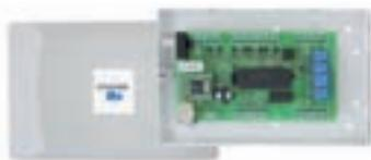
Basati su tecnologia TCP/IP di tipo stand-alone, i moduli IP Controller permettono di effettuare delle attivazioni e controllare
