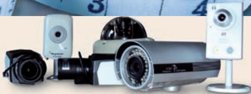
**2 Megapixel:** per l'interno una box camera (IPB2M) su cui utilizzare una delle varie lenti Megapixel a disposizione (2,4-6mm, 3-8mm, 2,8-8mm, 5-50mm); per l'esterno si può scegliere tra una bullet varifocale (IPE2M 3,6-16mm) con IR da 20 mt. e SD card incorporata ed una dome antivandalo varifocale (IPV2M 2,7-9mm) con IR da 15mt. Tutte con triplo streaming (H264, MPEG4, JPEG) ed alimentazione POE.
