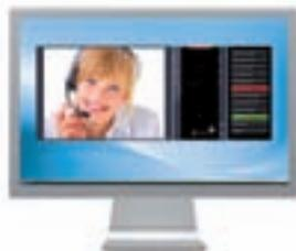
Commend, grazie al suo software Intercom Client, trasforma qualsiasi PC Windows® o Linux in una stazione interfonica, senza necessità di hardware aggiuntivo. In tal modo, PC e server interfonico si fondono e raggiungono una simbiosi perfetta e funzionale: sul monitor del PC viene visualizzata la classica stazione Commend con tastierino numerico, tasti funzione, display ed eventuale immagine video.
