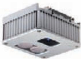
**Tailgate Detector**, abbinato ad un sistema di controllo accessi, intercetta il segnale emesso da un lettore ID (sistema a badge, RFID, biometrico), stabilisce se un individuo sta tentando di entrare e rileva la sua direzione di movimento. Nel caso di doppio ingresso o ingresso non autorizzato, è in grado di segnalare un allarme o bloccare i punti di accesso.
