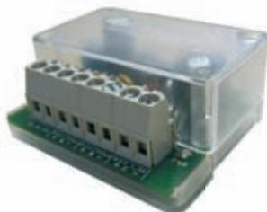
V 4512 è il nuovo riduttore di tensione munito di stabilizzatore interno e LED a luce fissa che ne segnala lo stato di "attivo". Ingresso in corrente continua da 16 Vdc a 42
