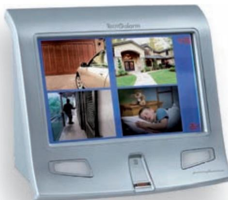
La console touch-screen (schermo di 7 pollici e lettore biometrico) permette di visualizzare real time quanto ripreso dalle telecamere via IP. Il sistema Videoalarm associa il segnale video alle varie zone controllate dai rilevatori: quando si rileva un evento, l'immagine della telecamera associata viene commutata a pieno schermo per un monitoraggio istantaneo della zona. Doc. Tecnoalarm.
