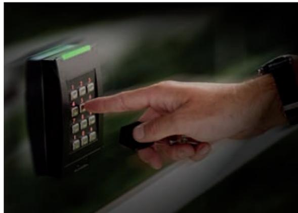
Una delle tecniche di riconoscimento automatico delle persone è basata sulla verifica di un PIN individuale digitato su una tastiera (doc. HID Global).
