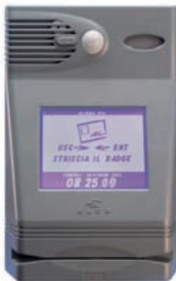
Controllo degli accessi fisici e rilevazione delle presenze sul lavoro possono convivere sullo stesso sistema. Nella foto un rilevatore presenze con elevata interattività uomo/macchina (doc. Elex)
