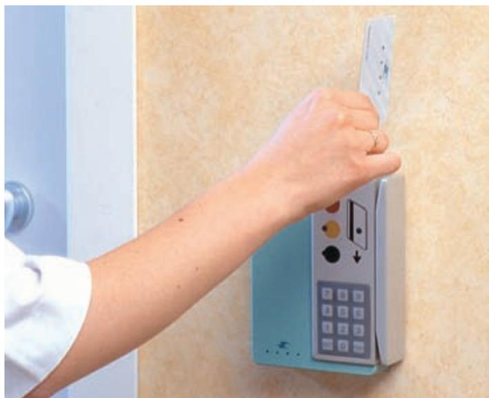
Un'unità elettronica di identificazione e controllo accessi basata su badge magnetico (ed eventuale PIN) installata di fianco alla porta di un'area riservata (Foto Elex).
